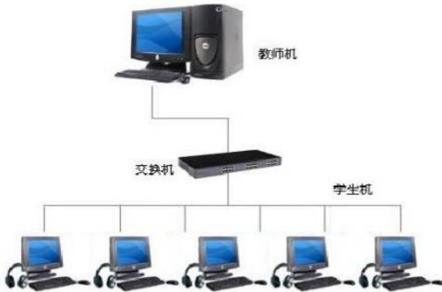
图 1 仿真系统局域网连接示意图
