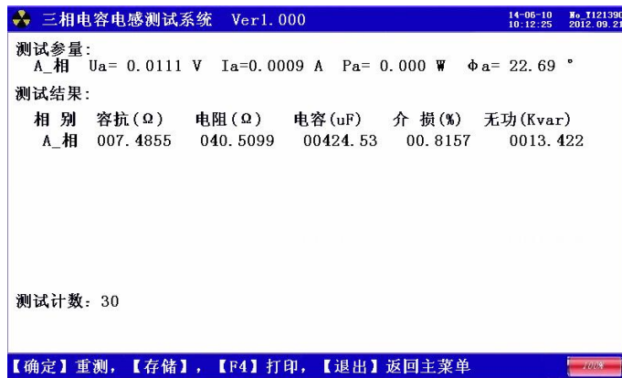
图 14、单相电容测试结果界面
