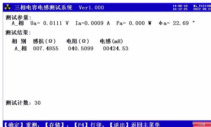
图 16、单相电感测试结果界面
